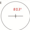
②将红色提示的十字准线瞄准被测物体，按下测量按键，开始测量
