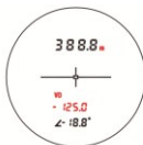
③松开测量键，得到垂直距离测量结果：红色-125米，其中“-”表示是目标在测距点的下方-18.8°为倾斜角（INC），388.8米为斜距。
