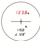
②将红色提示的十字准线瞄准被测物体，按住测量按键，让测距仪进入连续测量模式
