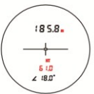
⑤松开测量按键，红色提示的为第一点和第二点之间的垂直高度差 (HT 信息)，斜距为 185.8 米，垂直高度差为 61 米，倾角为 18 度
