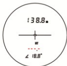
③松开测量键，得到斜率 (SD) 的测量结果，下方的“---”进入闪烁状态
