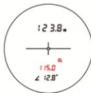
③ 松开测量键，得到测量结果，红色标记的115.0米为扫描测量中最近物体斜距，123.8米为当前斜距，12.8°为当前倾斜角。
