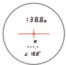
④将红色提示的十字准线瞄准第二个被测物体，按下测量键，开始测量第二个目标
