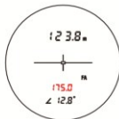
③ 松开测量键，得到测量结果，红色标记的175.0m为扫描测量中最远物体斜距，123.8m为当前测量的斜距，12.8°为当前倾斜角。
